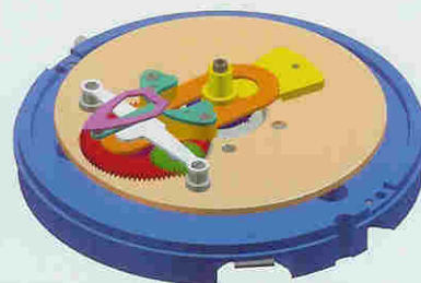
Darstellung von fünf Positionen während des Zeitraumes ante meridiem der Zahnräder A, B, D und E bei 24.00/0.00, 3.00, 6.00, 9.00 und 12.00 Uhr.
